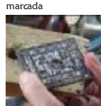
D.- Cortamos el metal por las marcas.
