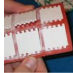
Desmoldeo de un molde Linka.
