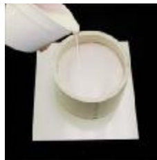
A2.- Vertido de la silicona sobre el recipiente que contiene el modelo.
