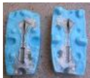
Pátina de polvo metálico aplicado al molde antes del colado.
